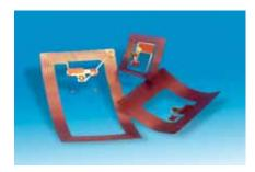
**ISM 2,45MHz:** Los transponders en esta frecuencia operan fundamentalmente detectando el campo eléctrico del interrogator, y su antena suele ser tipo "patch" balanceada.
