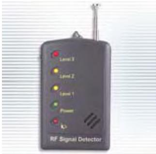
**DET-023SV** posee 3 Leds. Cuando detecta teléfono celular o cámara oculta, los leds encenderán de Nivel 1 a Nivel 2 y Nivel 3, emitiendo una señal sonora que cambiará de Lento a rápido la cual indicara la intensidad de señal detectada.
