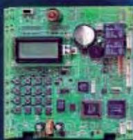
SY210NT Controlador de 2 puertas 4 lectores (software syw95a) 99 controladores - 9000 usuarios
