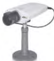
AXIS 211 Compresión MPEG-4 ASP Sensor imagen 1/4" Sony White Progressive Scan RGB CCD Tipo de lente 3.0-8mm F1.0 auto iris varifocal, asférica, rosca CS. PoE (IEEE802.3af).
