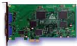
Placa digitalizadora tiempo real 16 can. 480 cuadros x seg. tecnología de alta calidad d1.
