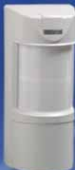
EDS 3000-TRIO Sensor para exteriores con PIR Quad y microondas Cobertura ajustable entre 90° y 180° Óptica y electrónica sellada Antiensucamiento Salida de relé de tiempo ajustable Potente filtro de luz solar y luz blanca Inmunidad a emisiones RF Antimascota hasta 40Kg Microondas banda K
