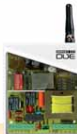
DRIVE DUE Central de comando de portones con tecnología BiDix®
