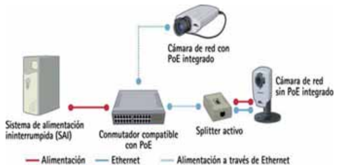
Un sistema que utiliza la Alimentación a través de Ethernet
