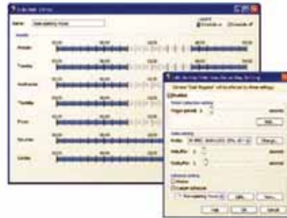
Configuración de grabación programada con una combinación de grabaciones continuas y activadas por alarma o movimiento aplicada mediante el software.
