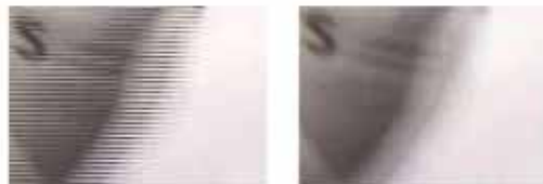
A la izquierda, un primer plano de una imagen entrelazada visualizada en una pantalla de ordenador; a la derecha, la misma imagen en la que se aplicó la técnica de desentrelazado.
