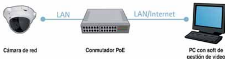
Una cámara de red se conecta directamente a la red.
