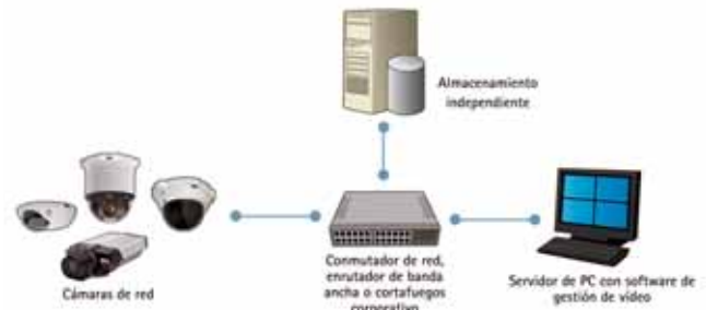
Almacenamiento conectado a red
