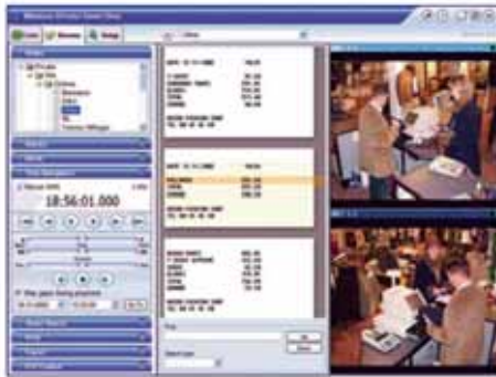
Un ejemplo de un sistema POS integrado con videovigilancia. Esta captura de pantalla muestra las recepciones junto con clips de video el evento.
