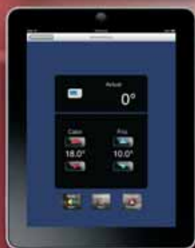
Control de climatización por zonas
