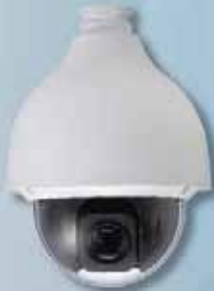
CVI-PTZ/20X-1M - Máx 450°/s pan speed - Entrada de audio - 2 entradas y 1 salida de alarma - IP 67 - 1.3Mp CMOS - Zoom 20x
